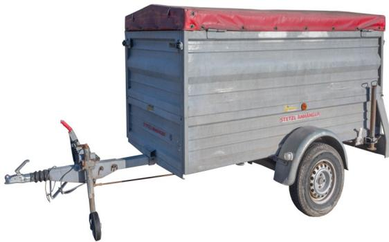
Anhänger für Versorgung, Fa. Stetzl, 2,3 m x 1,1 m x 1,4 m hoch mit Plane, BJ 2001, auflaufgebremst.
