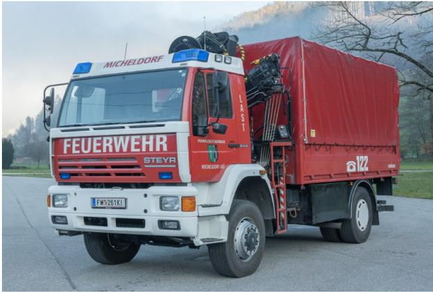
Last: Stützpunktfahrzeug, Steyr 18S28, Bj 2000, 206KW, GG: 18to, Ladekran Hiab 102, Kranbelegfahrzeug mit Anschlagmittel
