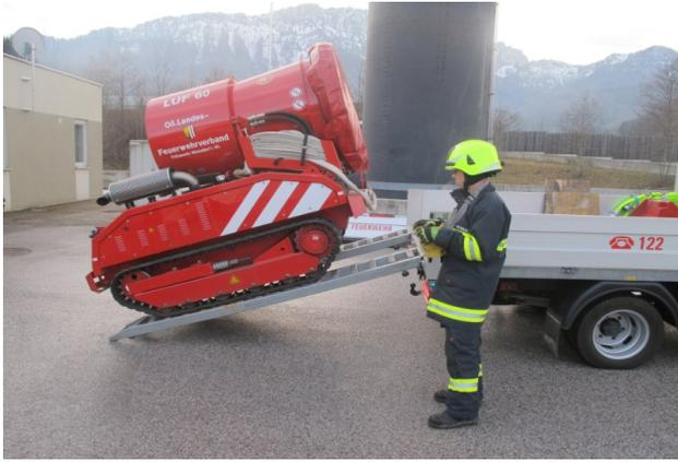
LUF 60: Stützpunktfahrzeug, Deutz Turbodiesel 78 KW, GG: 2,0 to, Wasserverbrauch 400l/min Lüfterleistung: 70.000m<sup>3</sup>/h. Fahrgeschwindigkeit max 6km/h, Steigfähigkeit 30°, Hydraulischer Antrieb, Ferngesteuert mit einer Reichweite von 300 m.
