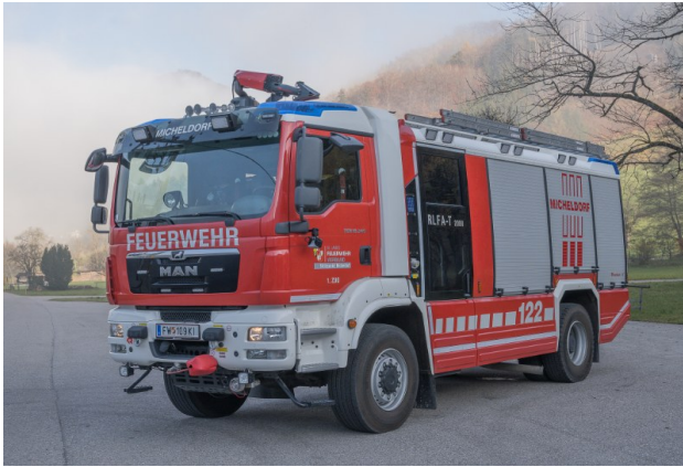
Tank 1: MAN TGM 18.340 4x4, Bj 2017, 2000 l Wasser, 200 l Schaummittel, Notstrom 14kVA, Seilwinde, 7 Atemschutzgeräte 300 bar, Überdruckklüfter, Tunnelausrüstung
