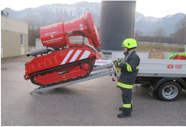
LUF 60: Stützpunktfahrzeug, Deutz Turbodiesel 78 KW, GG: 2,0 to, Wasserverbrauch 400l/min Lüfterleistung: 70.000m 3 /h. Fahrgeschwindigkeit max 6km/h, Steigfähigkeit 30°, Hydraulischer Antrieb, Ferngesteuert mit einer Reichweite von 300 m.
