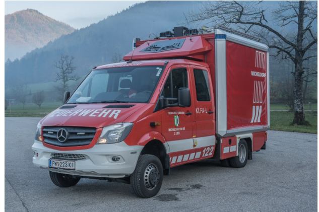
Pumpe 2: MB Sprinter 519, 4x4, Bj 2017, Turbodiesel, 140 KW, GG: 5,3 to, Lichtmast LED, Early Warner, Hebebühne mit 1000kg, Ausrüstung in 6 Rollcontainern
