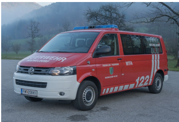
MTF 1: VW T5, Bj 2015, Turbodiesel, 150 PS, Mannschaftstransportfahrzeug mit Allrad, Feuerlöscher, Erste Hilfeeinrichtung, Anhängervorrichtung
