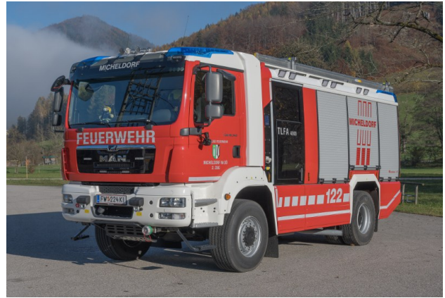
Tank 2: MAN TGM 18.340 4x4 BB, Bj 2020, 250KW, GG: 18 to, 4000l Wasser, Notstrom, Atemschutzgeräte 200 bar, Überdruckklüfter, 3 teilige 14 m Schiebeleiter
