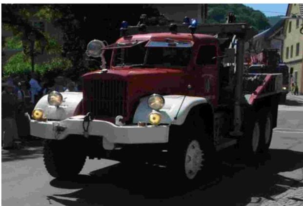
Oldtimer-Kranfahrzeug: Diamond, Hubleistung: 5 to, Seilwinde Zugkraft 18 to, Im Einsatz bei der FF Micheldorf: 1980 bis 1987
