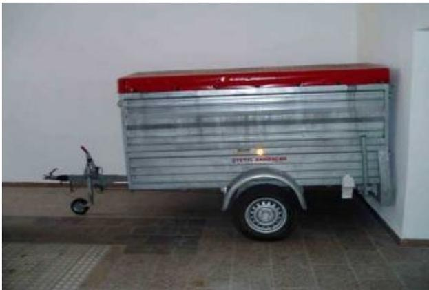
Anhänger für Versorgung, Fa. Stetzl, 2,3 m x 1,1 m x 1,4 m hoch mit Plane, BJ 2001, auflaufgebremst.
