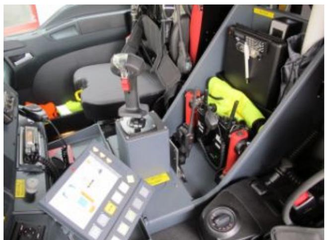
Fahrerkabine mit Joystick zur Steuerung des Wasserwerfers
