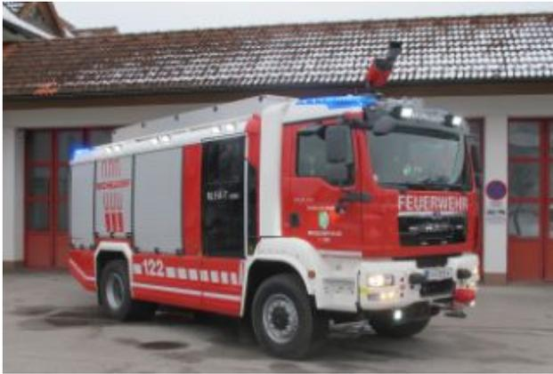
Tank 1: MAN TGM 18.340 4x4, Bj 2017, 4000 l Wasser, 200 l Schaummittel, Notstrom 14kVA, Seilwinde, 7 Atemschutzgeräte 300 bar, Überdrucklüfter, Tunnelausrüstung
