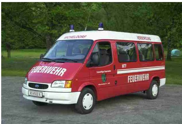
MTF 1: Ford Transit, Bj 1999, Turbodiesel, 73 KW, Mannschaftstransportfahrzeug, Feuer- löscher, Erste Hilfeeinrichtung, Anhängervorrich- tung
