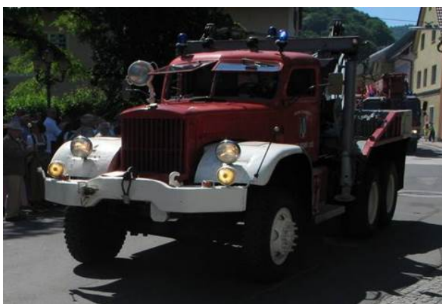
Kranfahrzeug: Diamond, Hubleistung: 5 to, Seilwinde Zugkraft 18 to, Im Einsatz bei der FF Micheldorf: 1980 bis 1987 (gekauft von der FF Wels)
