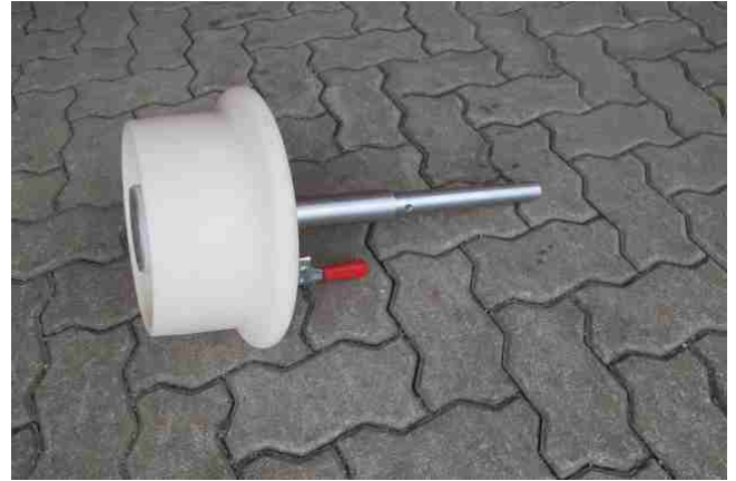
Rollen für die Rettungsplattform im SRF
