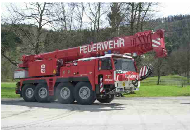
Kran: Stützpunktfahrzeug, Liebherr LTM 1070/1, Bj 1999, 300KW, GG: 48to, 50to Nennleistung, 20 to Rotzler Seilwinde, Oberwagenmotor 120KW
