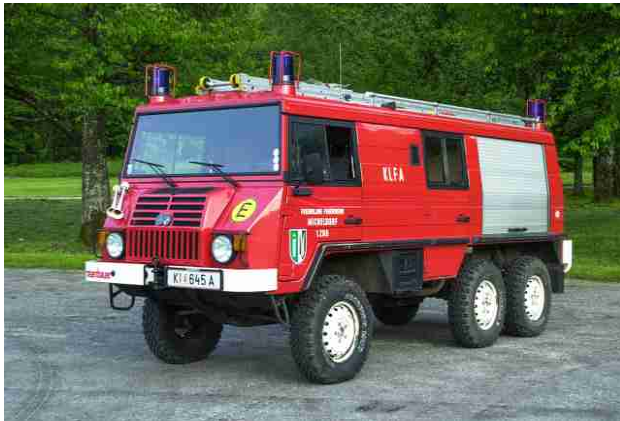
Pumpe 1: Steyr Daimler Puch Pinzgauer, Bj 1990, Turbodiesel, 77 KW, GG: 3,5 to. TS Fox 1 mit KLF Ausrüstung, alternativ mobiler Lastenlift, Baumkletterausrüstung
