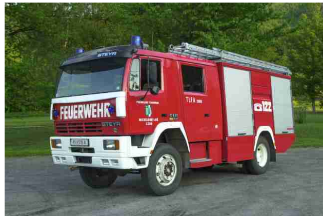
Tank 2: Steyr 13S21 4x4, Bj 1988, 154KW, GG: 13 to, 2000l Wasser, Notstrom 8 kVA, Säure- und Vollschanzanzüge, Atemschutzgeräte 200 bar, Überdrucklüfter, 3 teilige 14 m Schiebeleiter
