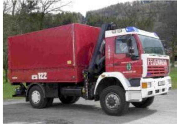
**Last: Steyr 18S28, Bj 2000, 206KW, GG: 18to, Stützpunktfahrzeug**
