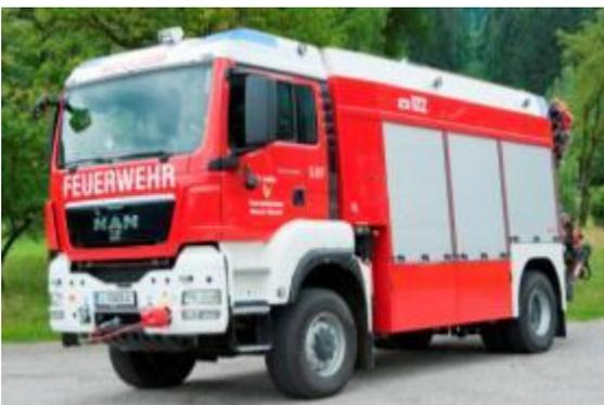
**SRF: MAN 18.360 TGS 4x4, Bj 2009, 265KW Euro 4, GG: 18to, Stützpunktfahrzeug**
