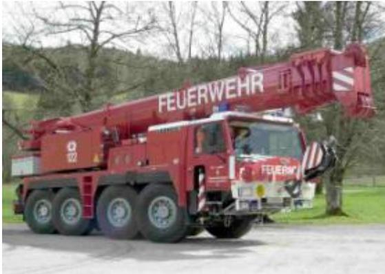
**Kran: Liebherr LTM 1070/1, Bj 1999, 300KW, GG: 48to, Stützpunktfahrzeug**
