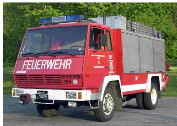
**SRF:** Steyr 791 4x4, Bj 1982, 143KW, GG: 14to, Stützpunktfahrzeug
