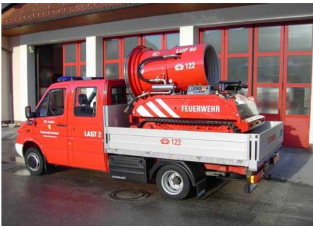
**Last 2: Mercedes Benz Sprinter 416 CDI**, Bj 2004, Turbodiesel, 115KW, GG: 4,6to. Trägerfahrzeug für Luf 60
