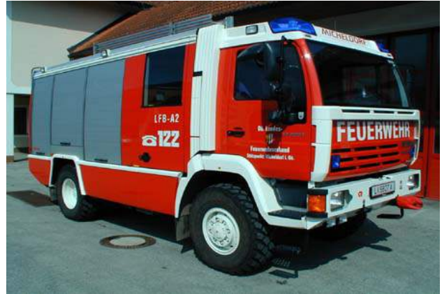
Pumpe 2: Stützpunktfahrzeug, Steyr 12S22 4x4, Bj 2002, 163 KW, GG: 12 to, Absetzblock mit TS Fox 3, integrierte Schlauchhaspel, Notstrom, 5to Einbauseilwinde, Atemschutz 200bar, Tauchpumpen, Nasssauger
