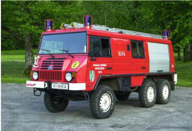
Pumpe 1: Steyr Daimler Puch Pinzgauer, Bj 1990, Turbodiesel, 77 KW, GG: 3,5 to. TS Fox 3 mit KLF Ausrüstung, alternativ mobiler Lastenlift, Baumkletterausrüstung
