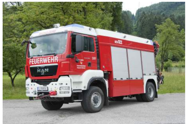
SRF: Stützpunktfahrzeug, MAN 18.360 TGS 4x4, Bj 2009, 265KW Euro 4, GG: 18to, Generator 40 kVA, Lichtmast Flexilight, Seilwinde Rotzler 8to Zug, 80m Seil, Ladekran Hiab 166E-5, Umfangreiche Technische Beladung
