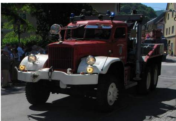
Oldtimer-Kranfahrzeug: Diamond, Hubleistung: 5 to, Seilwinde Zugkraft 18 to, Im Einsatz bei der FF Micheldorf: 1980 bis 1987
