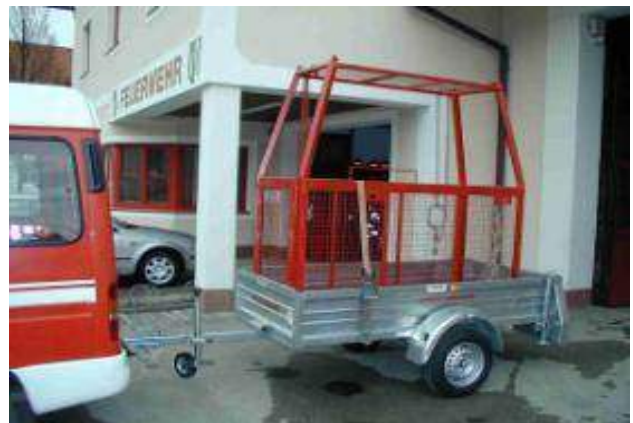
Anhänger für Rettungskorb, Fa. Stetzl, 2,3 m x 1,1 m, BJ 2002, ungebremst
