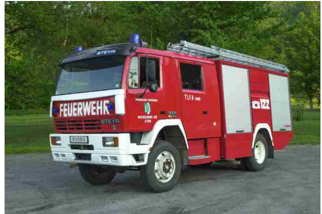
Tank 2: Steyr 13S21 4x4, Bj 1988, 154KW, GG: 13 to, 2000l Wasser, Notstrom 8 kVA, Säure- und Vollschutzanzüge, Atemschutzgeräte 200 bar, Überdrucklüfter, 3 teilige 14 m Schiebeleiter
