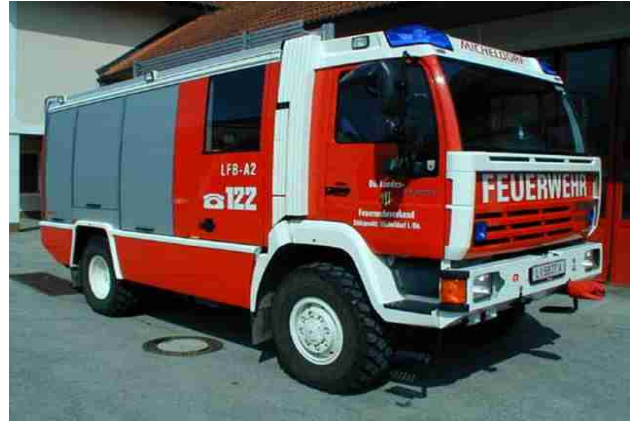
Pumpe 2: Stützpunktfahrzeug, Steyr 12S22 4x4, Bj 2002, 163 KW, GG: 12 to, Absetzblock mit TS 12, integrierte Schlauchhaspel, Notstrom, 5to Einbauseilwinde, Atemschutz 200bar, Tauchpumpen, Nasssauger
