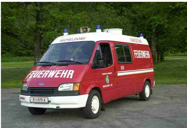
KDO: Ford Transit, Bj 1994, Turbodiesel, 73 KW, Spreizer, Schere, Hebekissen, Notstrom, Beleuchtung, Erste Hilfe, Lotsen- und Kommandoeinrichtungen
