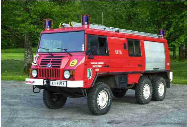
Pumpe 1: Steyr Daimler Puch Pinzgauer, Bj 1990, Turbodiesel, 77 KW, GG: 3,5 to. TS Fox mit KLF Ausrüstung, alternativ mobiler Lastenlift, Baumkletterausrüstung
