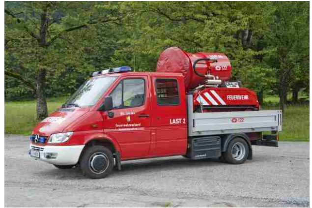
Last 2: Stützpunktfahrzeug, Mercedes Benz Sprinter 416 CDI , Bj 2004, Turbodiesel, 115 KW, GG: 4,6 to. Trägerfahrzeug für Luf 60
