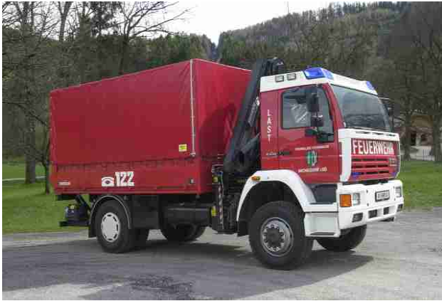
Last: Stützpunktfahrzeug, Steyr 18S28, Bj 2000, 206KW, GG: 18to, Ladekran Hiab 102, Kranbegleitfahrzeug mit Anschlagmittel
