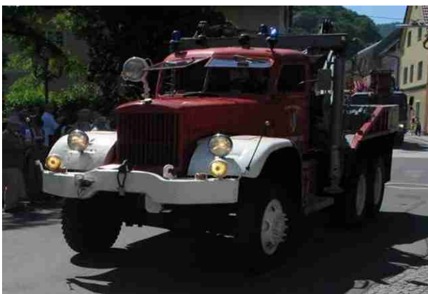
Kranfahrzeug: Diamond, Hubleistung: 5 to, Seilwinde Zugkraft 18 to, Im Einsatz bei der FF Micheldorf: 1980 bis 1987 (gekauft von der FF Wels)
