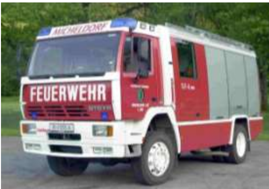
Tank 1: Steyr 16S26 4x4, Bj 1996, 191KW, GG: 16to 4000l Wasser, 200l Schaummittel, Notstrom 8kVA, Atemschutzgeräte 300bar, Überdrucklüfter.
