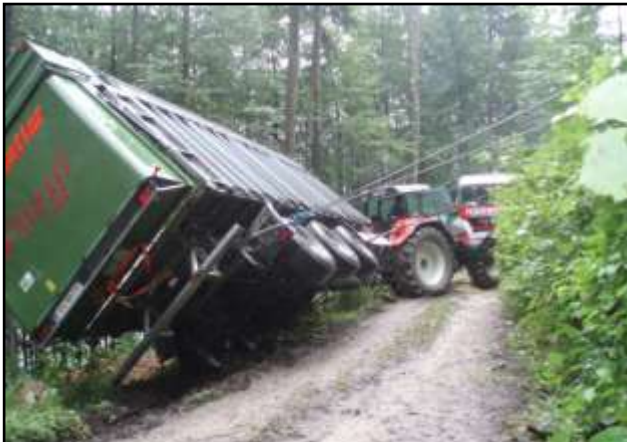
Bergung eines Traktoranhängers in Molln. Mit 5 losen Rollen und 80 m Seil!
