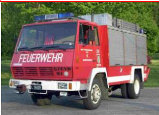
SRF: Steyr 791 4x4, Bj 1982, 143KW, GG: 14to, Stützpunktfahrzeug Waldbrandcontainer, 5 to Rotzler Seilwinde, 20kVA Generator, Schweißbrenner, Hebekissen, Dichtkissen,... Ausser Dienst gestellt: 05. Juli 2009
