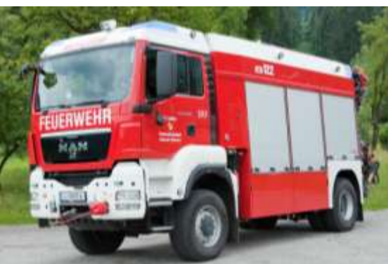
SRF: MAN 18.360 TGS 4x4, Bj 2009, 265KW Euro 4, GG: 18to, Stützpunktfahrzeug Generator 40 kVA, Lichtmast Flexilight, Seilwinde Rotzler 8to Zug, 80m Seil, Ladekran Hiab 166E-5, Umfangreiche Technische Beladung
