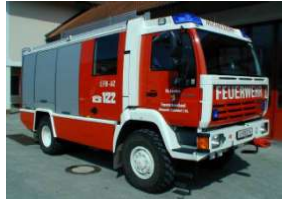
Pumpe 2: Steyr 12S22 4x4, Bj 2002, 163KW, GG: 12to Absetzblock mit TS 12, integrierte Schlauchhaspel, Notstrom, 5to Einbauseilwinde, Atemschutz 200bar, Tauchpumpen, Naßsauger
