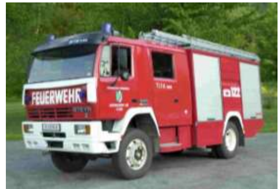
Tank 2: Steyr 13S21 4x4, Bj 1988, 154KW, GG: 13to 2000l Wasser, Notstrom 8kVA, Säure- & Vollschutzanzüge, Atemschutzgeräte 200bar, Überdrucklüfter, 3 teilige 14m Schiebeleiter
