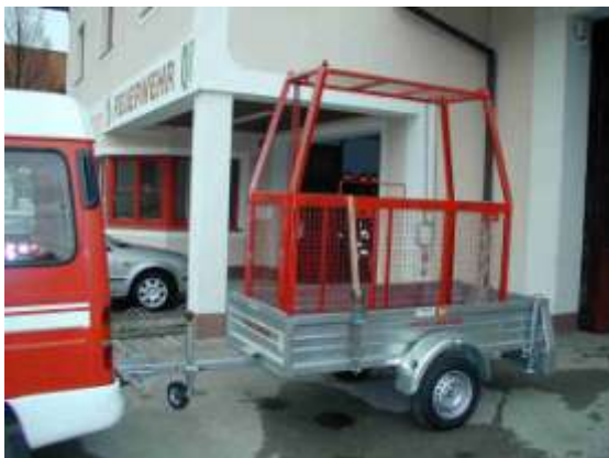
Anhänger für Rettungskorb, Fa. Stetzl, 2,3m x 1,1m, BJ 2002, ungebremst Nicht abgebildet:
