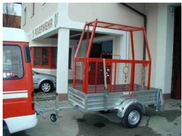
Anhänger für Rettungskorb, Fa. Stetzl, 2,3m x 1,1m, BJ 2002, ungebremst
