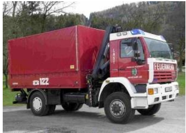
Last: Steyr 18S28, Bj 2000, 206KW, GG: 18to, Stützpunktfahrzeug Ladekran Hiab 102, Kranbegleitfahrzeug mit Anschlagmittel,....
