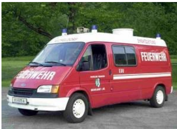
KDO: Ford Transit, Bj 1994, Turbodiesel, 73KW Spreitzer, Schere, Hebekissen, Notstrom, Beleuchtung, Erste Hilfe, Lotsen- & Kommandoeinrichtungen
