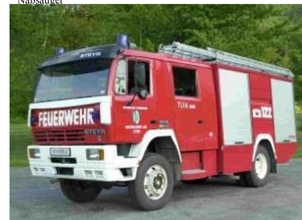
Tank 2: Steyr 13S21 4x4, Bj 1988, 154KW, GG: 13to 2000l Wasser, Notstrom, Säure- & Vollschatzanzüge, Atemschutz, Überdrucklüfter, 3 teilige 14m Schiebeleiter
