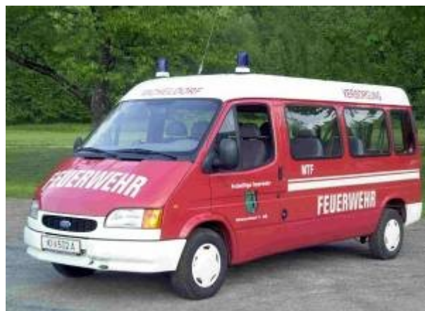
MTF: Ford Transit, Bj 1999, Turbodiesel, 73KW Mannschaftstransportfahrzeug, Feuerlöscher, Erste Hilfeeinrichtung, Anhängervorrichtung
