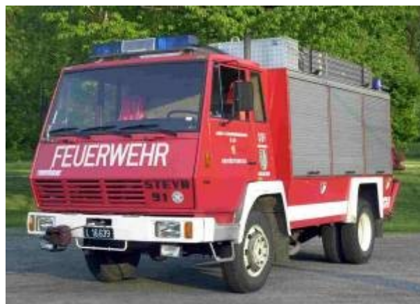
SRF: Steyr 791 4x4, Bj 1982, 143KW, GG: 14to, Stützpunktfahrzeug Waldbrandcontainer, 5 to Rotzler Seilwinde, 20kVA Generator, Schweißbrenner, Hebekissen, Dichtkissen,...
