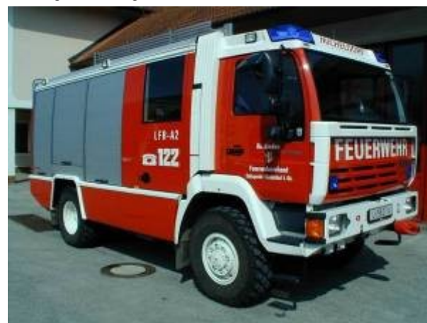
Pumpe 2: Steyr 12S22 4x4, Bj 2002, 163KW, GG: 12to Absetzblock mit TS 12, integrierte Schlauchhaspel, Notstrom, 5to, Einbauseilwinde, Atemschutz 330bar, Tauchpumpen, Naßsauger
