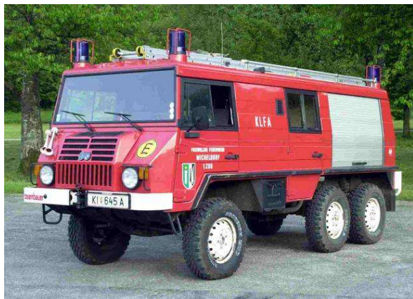
Pumpe 1: Steyr Daimler Puch Pinzgauer, Bj 1990, Turbodiesel, 77KW, GG: 3,5to. TS Fox mit KLF Ausrüstung, alternativ mobiler Lastenlift, Baumkletterausrüstung.
