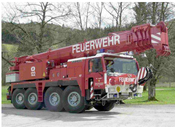
Kran: Liebherr LTM 1070/1, Bj 1999, 300KW, GG: 48to, Stützpunktfahrzeug 50to Nennleistung, 20 to Rotzler Seilwinde, Oberwagenmotor 120KW
