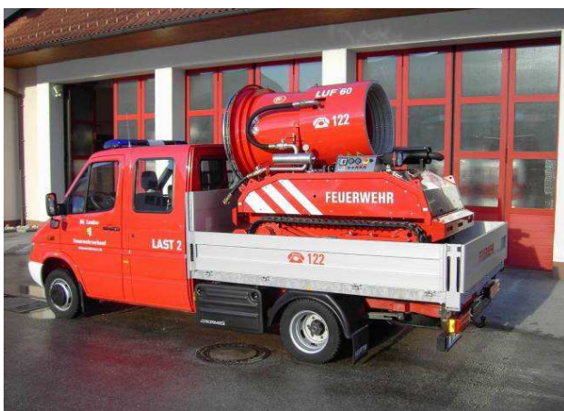
Last 2: Mercedes Benz Sprinter 416 CDI, Bj 2004, Turbodiesel, 115KW, GG: 4,6to. Trägerfahrzeug für Luf 60
