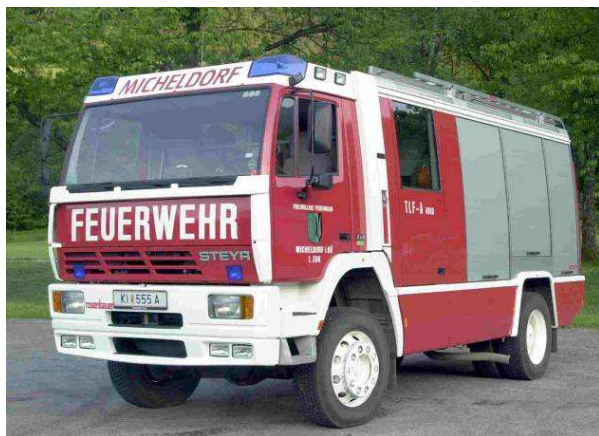
Tank 1: Steyr 16S26 4x4, Bj 1996, 191KW, GG: 16to 4000l Wasser, Notstrom, Atemschutz, Überdrucklüfter
