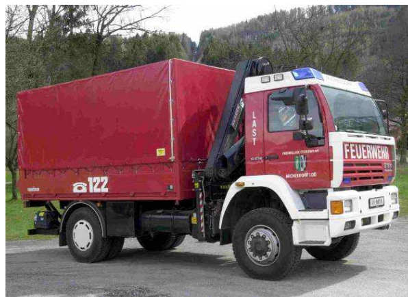
Last: Steyr 18S28, Bj 2000, 206KW, GG: 18to, Stützpunktfahrzeug Ladekran Hiab 102, Kranbegleitfahrzeug mit Anschlagmittel,....
