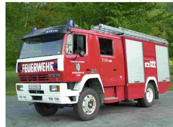
Tank 2: Steyr 13S21 4x4, Bj 1988, 154KW, GG: 13to 2000l Wasser, Notstrom, Säure- & Vollschutzanzüge, Atemschutz, Überdrucklüfter, 3 teilige 14m Schiebeleiter
