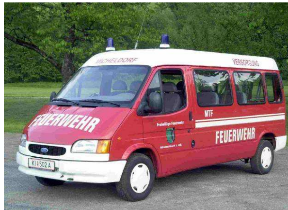
MTF: Ford Transit, Bj 1999, Turbodiesel, 73KW Mannschafttransportfahrzeug, Feuerlöscher, Erste Hilfeeinrichtung, Anhängervorrichtung
