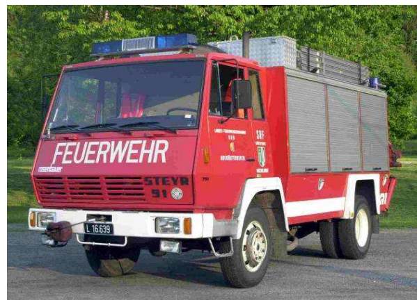
SRF: Steyr 791 4x4, Bj 1982, 143KW, GG: 14to, Stützpunktfahrzeug Waldbrandcontainer, 5 to Rotzler Seilwinde, 20kVA Generator, Schweißbrenner, Hebekissen, Dichtkissen,...
