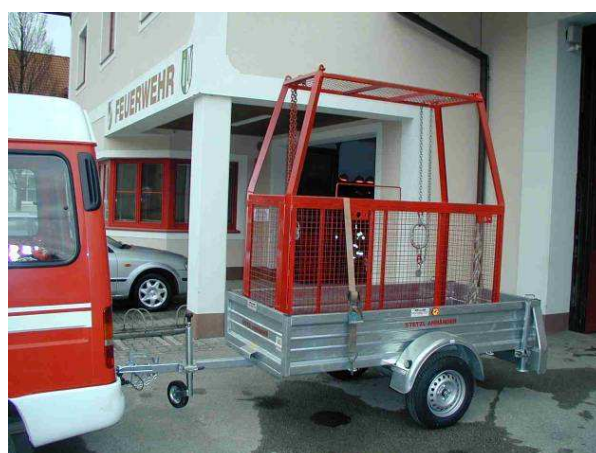
Anhänger für Rettungskorb, Fa. Stetzl, 2,3m x 1,1m, BJ 2002, ungebremst
