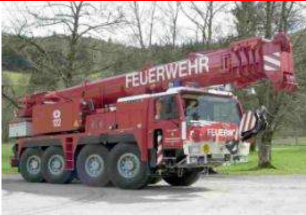
Kran: Liebherr LTM 1070/1, Bj 1999, 300KW, GG: 48to, Stützpunktfahrzeug 50to Nennleistung, 20 to Rotzler Seilwinde, Oberwagenmotor 120KW
