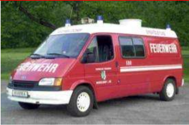
KDO: Ford Transit, Bj 1994, Turbodiesel, 73 KW Spreizer, Schere, Hebekissen, Notstrom, Beleuchtung, Erste Hilfe, Lotsen- & Kommandoeinrichtungen
