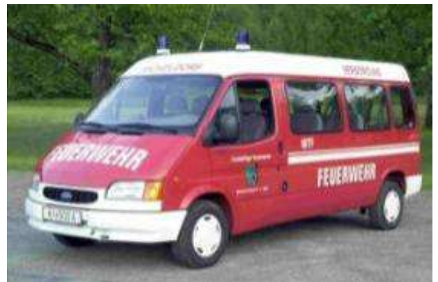
MTF 1: Ford Transit, Bj 1999, Turbodiesel, 73 KW Mannschaftstransportfahrzeug, Feuerlöscher, Erste Hilfeeinrichtung, Anhängervorrichtung
