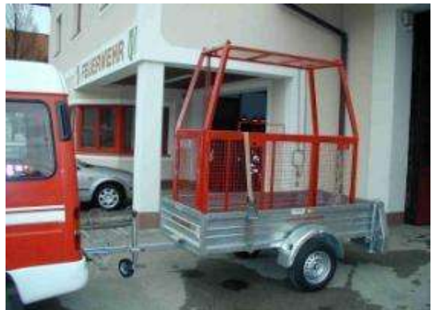
Anhänger für Rettungskorb, Fa. Stetzl, 2,3 m x 1,1 m, BJ 2002, ungebremst Nicht abgebildet:
