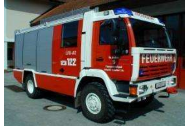
Pumpe 2: Steyr 12S22 4x4, Bj 2002, 163 KW, GG: 12 to Absetzblock mit TS 12, integrierte Schlauchhaspel, Notstrom, 5to Einbauseilwinde, Atemschutz 200bar, Tauchpumpen, Naßsauger
