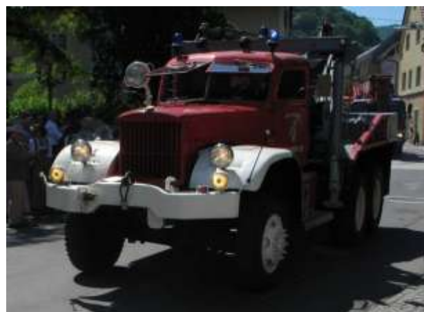
Kranfahrzeug: Dodge, Hubleistung: 5 to, Seilwinde Zugkraft 18 to, Im Einsatz: 1980 bis 1987 gekauft von der FF Wels.
