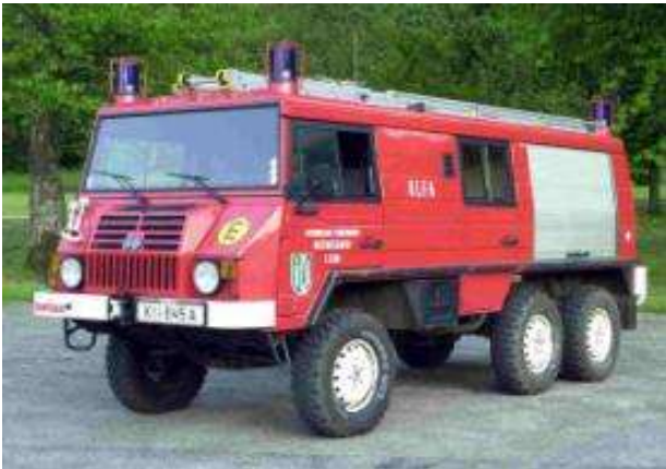
Pumpe 1: Steyr Daimler Puch Pinzgauer, Bj 1990, Turbodiesel, 77 KW, GG: 3,5 to. TS Fox mit KLF Ausrüstung, alternativ mobiler Lastenlift, Baumkletterausrüstung.
