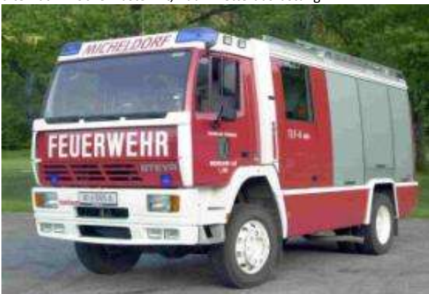
Tank 1: Steyr 16S26 4x4, Bj 1996, 191KW, GG: 16 to 4000 l Wasser, 200 l Schaummittel, Notstrom 8 kVA, Atemschutzgeräte 300 bar, Überdrucklüfter.
